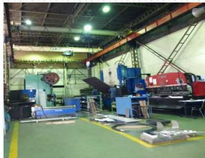
▶事業内容:鉄板一枚からレーザーやベンダー等の加工機械を使用して多品種少量生産を行う。「1個のプラモデル納品72H」をキャッチコピーに、72時間以内に納品し、1個から対応している。
