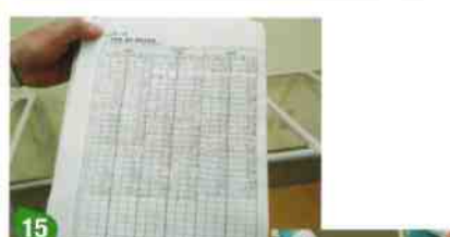
15・16 乾燥室の「温度・湿度記録表」(上)と、干し網の段ごとに乾燥の度合いを10段階評価し、記録する「乾燥状況表」(右)。こうして、検証と改善のためのデータを毎日、集めている
