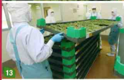
11 広いスペースが確保された乾燥室。洗浄した葉を干し網の上で一晩乾かす。天井にはオゾン殺菌装置(矢印)が設置されており、衛生的な室内環境を維持している 12 破れや汚れなどが確認しながら、葉を一枚一枚、丁寧に干し網に並べていく 13 並べ終わると、干し網をキャスター付きの台に移し、10段ほどの高さに積み上げていく 14 こうした作業では、奥に手を伸ばすときに最も腰に負担が掛かる。だが、傾斜を付けることで、姿勢が楽になる。また、爪先を奥に入れられるスペース(丸囲み)を確保することで、足が踏ん張りやすくなる。現場にしか分からない悩みがあるから、皆でつくり上げる工場にはこうした改善が生まれてくる
