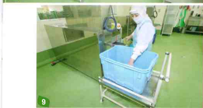
8 洗浄室の全景。2台の洗浄・脱水装置が見える。窓ガラスの向こう側は、次工程である乾燥室だ。右側に見えるシンクは、機械に通せない若葉や紅葉葉など、デリケートな葉を手洗いする際に使用する 9 洗浄・脱水装置と投入作業の様子。投入した葉は、そのまま壁の向こうの乾燥室に運ばれる。一貫ラインになってからは、1オペレーターでこなせるようになり、必要となる手作業も減ったため、「以前と比べて非常に楽になり、作業も速くなりました」(長濱さん)という 10 塩気が高くなる室内環境のため、エアコンや換気扇などの設備も耐塩仕様になっている
