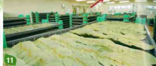
11 広いスペースが確保された乾燥室。洗浄した葉を干し網の上で一晩乾かす。天井にはオゾン殺菌装置(矢印)が設置されており、衛生的な室内環境を維持している 12 破れや汚れなどが確認しながら、葉を一枚一枚、丁寧に干し網に並べていく 13 並べ終わると、干し網をキャスター付きの台に移し、10段ほどの高さに積み上げていく 14 こうした作業では、奥に手を伸ばすときに最も腰に負担が掛かる。だが、傾斜を付けることで、姿勢が楽になる。また、爪先を奥に入れられるスペース(丸囲み)を確保することで、足が踏ん張りやすくなる。現場にしか分からない悩みがあるから、皆でつくり上げる工場にはこうした改善が生まれてくる
