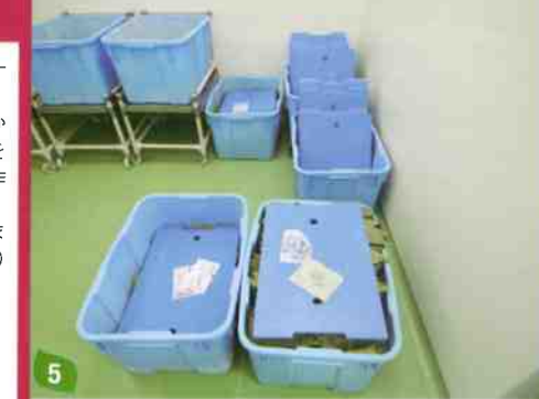
5 冷蔵庫内で行われる塩抜き。コンテナに真水を張り、一晩漬ける 6 台車がなかったときは、このようにかがんで、床の上でコンテナを傾けて水を流していた。腰に大きな負担が掛かる作業だ 7 現在はコンテナを専用台車に乗せたまま移動や作業ができ、水は蛇口(丸囲み)から簡単に抜けるようになった
